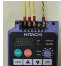
Entrada trifásica (modelos -NFU, -HFEF, -HFU)
