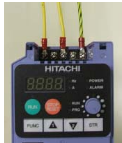
Entrada monofásica (modelos -SFEF y -NFU)
